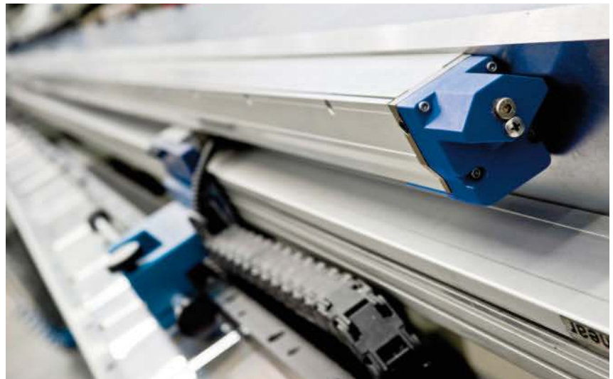
1 Wegmesssystem von Fagor, basierend auf hochwertiger optischer Technik: Mittlerweile können Verfahrswege von bis zu 40 m abgedeckt werden
