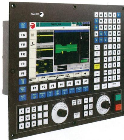
4 Die CNC-Steuerung Fagor 8070 ist dank der Dialog-Programmierung leicht zu bedienen (© Fagor)
