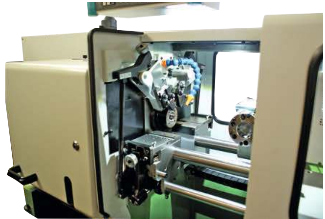
1 Vorher – nachher: Wachtler bringt die soliden Traub-TD-Kurvendrehmaschinen dank Fagor-Steuerung beim Retrofit ins CNC-Zeitalter
