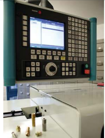
3 Die leicht adaptierbare Fagor-8037-Steuerung eignet sich bestens für das Retrofitting zweiachsiger Drehmaschinen
