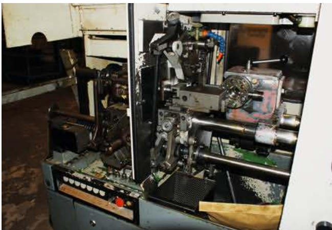
1 Vorher – nachher: Wachtler bringt die soliden Traub-TD-Kurvendrehmaschinen dank Fagor-Steuerung beim Retrofit ins CNC-Zeitalter
