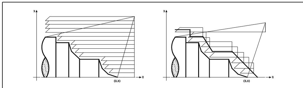
Wenn man die Rohlingskontur des Werkstücks kennt, ist es ratsam, beide Profile zu definieren: Die Kontur des Werkstückrohlings und die gewünschte endgültige Kontur. Die Bearbeitung ist schneller, denn es wird nur Material, das von beiden Konturen begrenzt wird, abgetragen.
