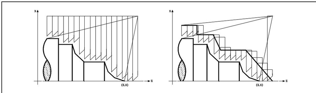
Wenn man die Rohlingskontur des Werkstücks kennt, ist es ratsam, beide Profile zu definieren: Die Kontur des Werkstückrohlings und die gewünschte endgültige Kontur. Die Bearbeitung ist schneller, denn es wird nur Material, das von beiden Konturen begrenzt wird, abgetragen.
