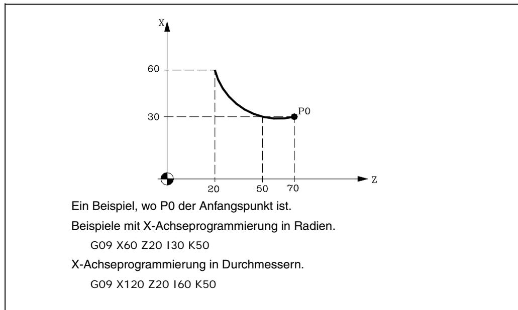
Funktion G09 ist nicht modal und muss daher stets programmiert werden, wenn ein durch drei Punkte definierter Kreisbahnverlauf ausgeführt werden soll. Funktion G09 kann als G9 programmiert werden.
