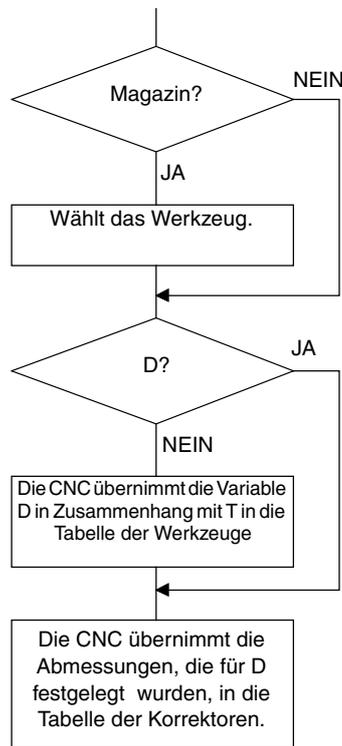
Verfügt die Maschine über ein Werkzeugmagazin, konsultiert die CNC die "Werkzeugmagazintabelle" und bringt so die Position in Erfahrung, die das gewünschte Werkzeug einnimmt.
