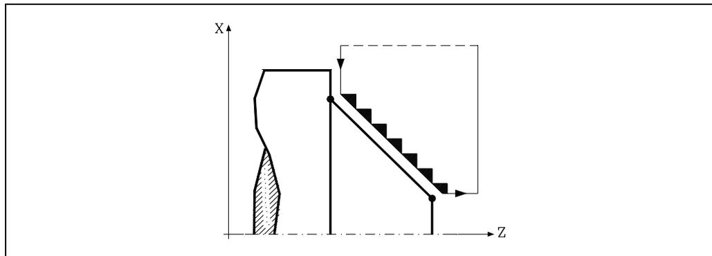
Der Zyklus endet nach dem Plandrehen (mit oder ohne Durchlauf zur Fertigstellung) immer an dem Punkt, wo der Zyklus aufgerufen wurde.
