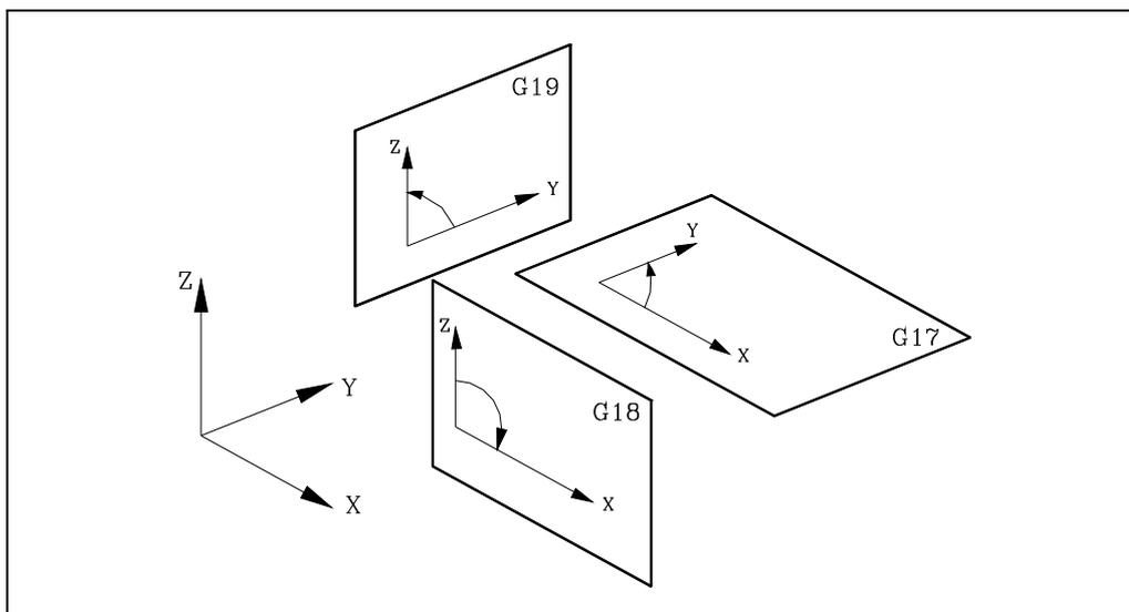
Beim Einschalten der Betriebsspannung und nach Durchführung von M02/M30 und nach einem NOTHALT oder einem RÜCKSETZ-Vorgang geht die CNC auf die im allgemeinen Maschinenparameter als IPLANE definierte Ebene als Arbeitsebene über.
