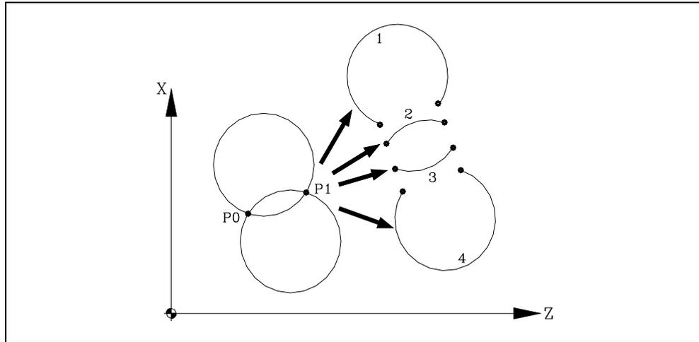
Wenn P0 der Startpunkt und P1 der Endpunkt sind, können 4 Kreisbögen mit den selben Werten durch die beiden Punkte gelegt werden.
