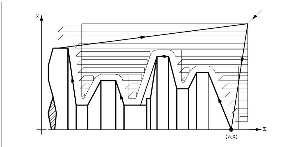
Sobald erst einmal der Durchlauf zur Fertigstellung beendet wurde, fährt das Werkzeug zu dem Punkt zurück, wo der Aufruf des Zykluses erfolgte.
