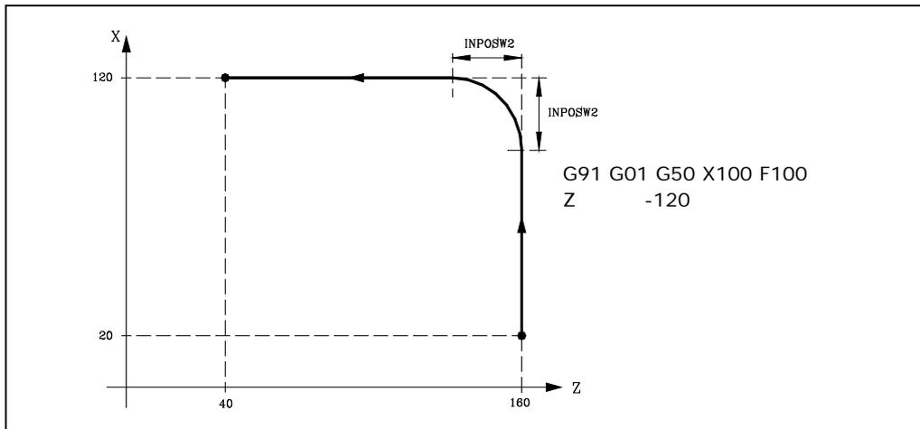
Die Funktion G50 stellt sicher, dass der Unterschied zwischen der theoretischen und der praktischen Bahn kleiner bleibt, als im Maschinenparameter INPOSW2 gesetzt ist.
