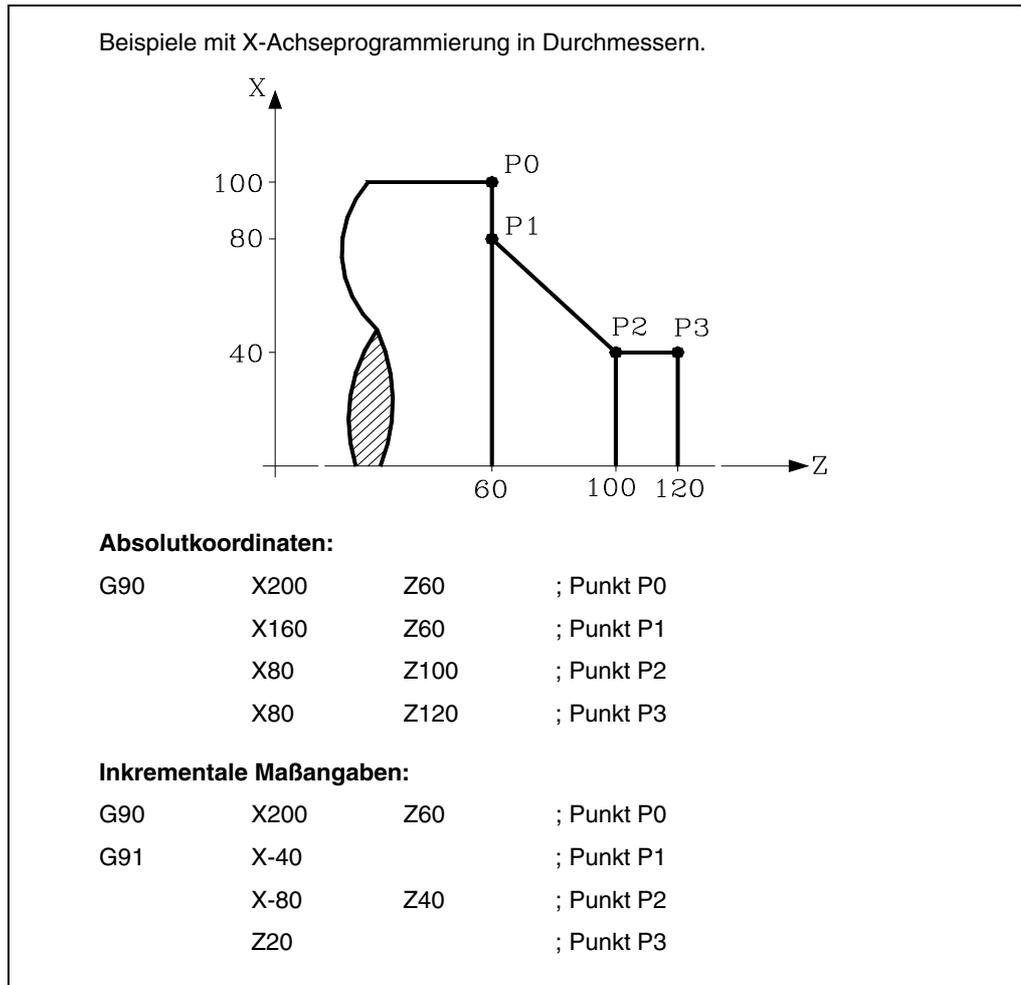
Beim Einschalten der Betriebsspannung, nach Durchführung von M02/M30 sowie nach einem NOTHALT oder einem RÜCKSETZ-Vorgang geht die CNC auf das im allgemeinen Maschinenparameter ISYSTEM definierte System G90 oder G91 über.
