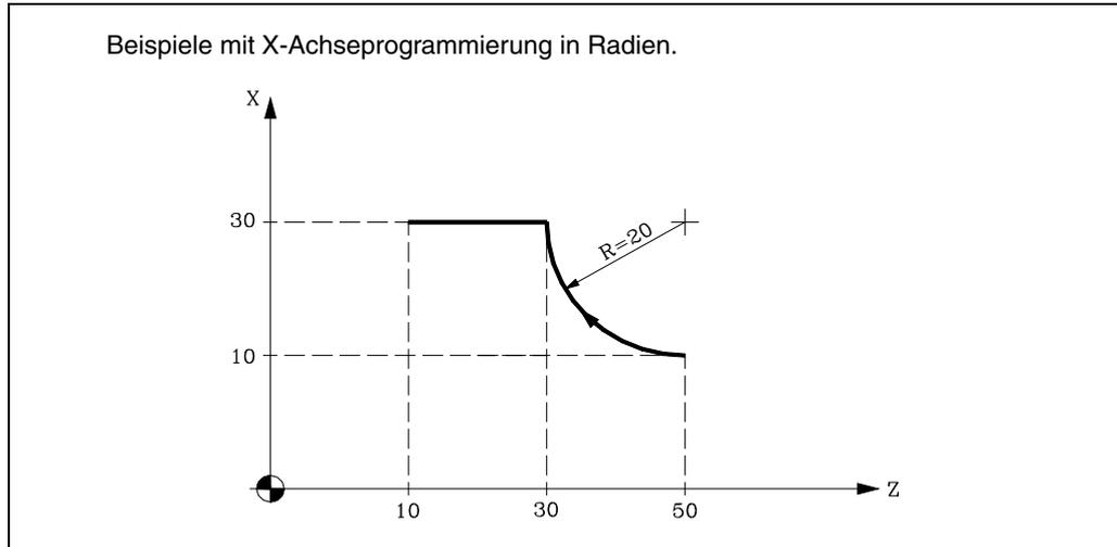
Der Startpunkt sei bei X10 Z50 und es soll ein Kreisbogen erzeugt werden (Zustellbahn ist eine Gerade); dann ist zu programmieren:
