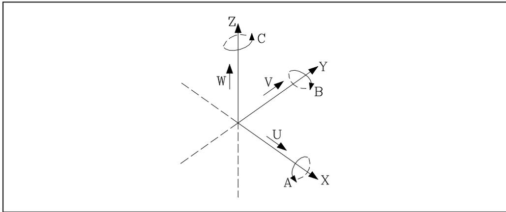
Die einzelnen Achsen des Achsensystems:
