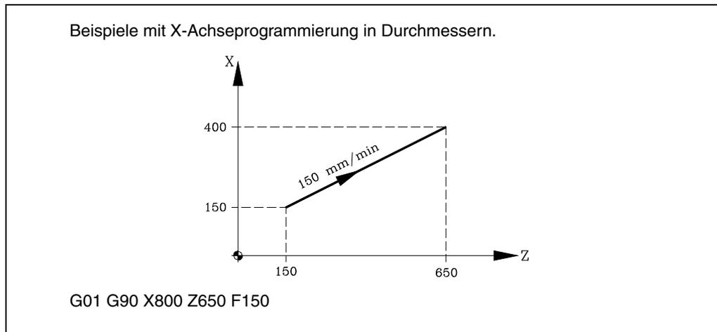
Die programmierte Vorschubgeschwindigkeit kann mittels des Schalters an der CNC-Bedientafel im Bereich von 0% bis 120% und von der PLC, von der DNC oder durch das Programm im Bereich von 0% bis 255% variiert werden.
