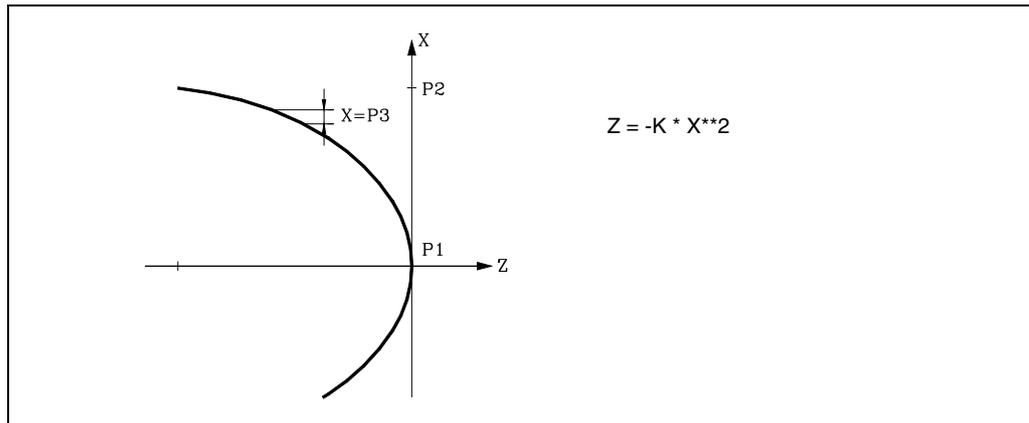
Die X-Achseprogrammierung ist in Durchmessern und Unterprogramm 2 findet Verwendung; dessen Parameter haben folgende Bedeutungen:
