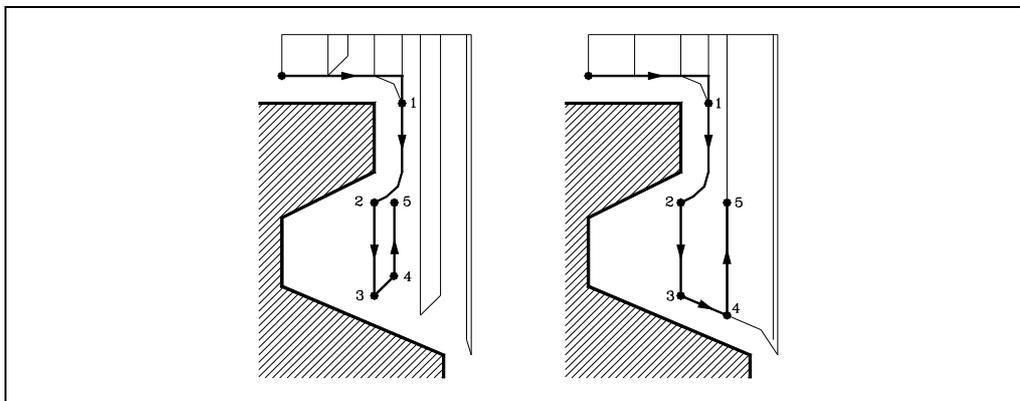
1. Von hier aus folgt man mit der Funktion G01 der einprogrammierten Kontur, wobei das Schlichtaufmaß erhalten bleibt, bis die Tiefe für den gewählten Durchlauf "C" erreicht ist. Abschnitt 1-2.
