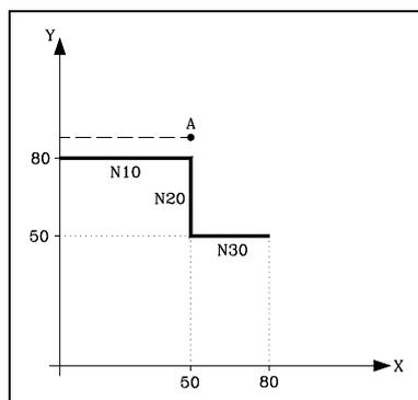
Satz N15 unterbricht die Satzvorbereitung; die Abarbeitung des Satzes N10 endet bei Punkt A.
