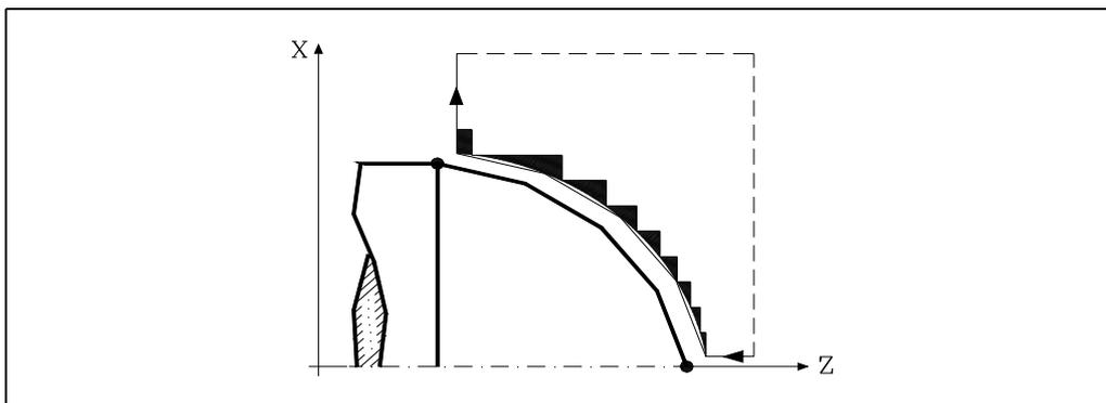
Der Zyklus endet nach dem Drehen (mit oder ohne Durchlauf zur Fertigstellung) immer an dem Punkt, wo der Zyklus aufgerufen wurde.
