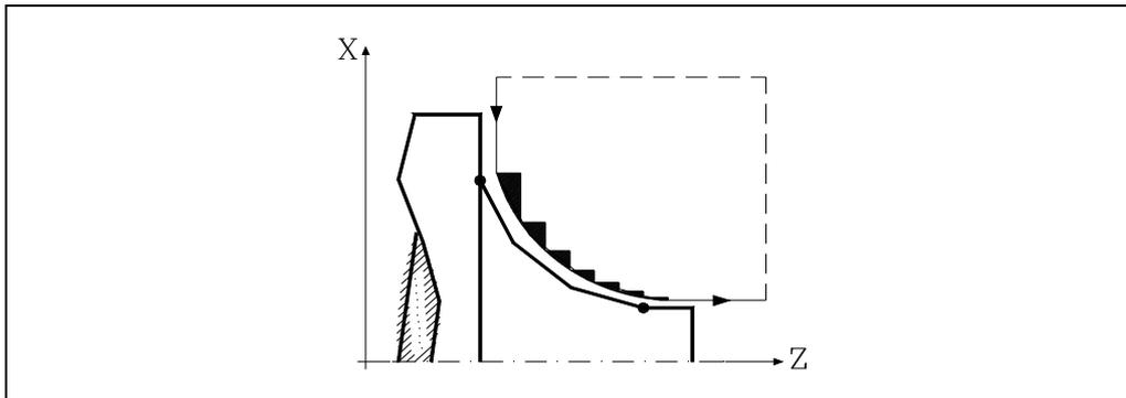
Der Zyklus endet nach dem Plandrehen (mit oder ohne Durchlauf zur Fertigstellung) immer an dem Punkt, wo der Zyklus aufgerufen wurde.
