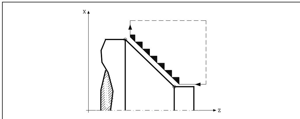
Der Zyklus endet nach dem Drehen (mit oder ohne Durchlauf zur Fertigstellung) immer an dem Punkt, wo der Zyklus aufgerufen wurde.
