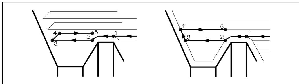
1. Von hier aus folgt man mit der Funktion G01 der einprogrammierten Kontur, wobei das Schlichtaufmaß erhalten bleibt, bis die Tiefe für den gewählten Durchlauf "C" erreicht ist. Abschnitt 1-2.
