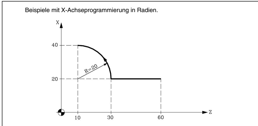
Der Startpunkt sei bei X20 Z60 und es soll ein Kreisbogen erzeugt werden (Zustellbahn ist eine Gerade); dann ist zu programmieren:
