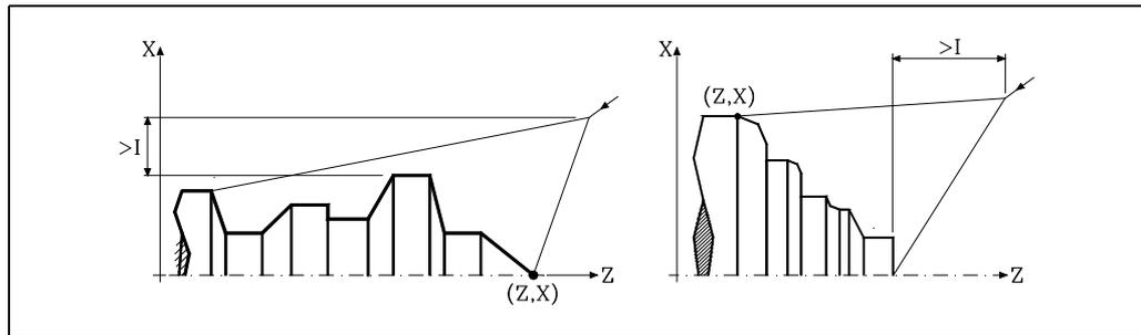
Wenn die Werkzeugposition nicht richtig für die Ausführung des Zykluses ist, zeigt die CNC eine entsprechende Fehlermeldung an.
