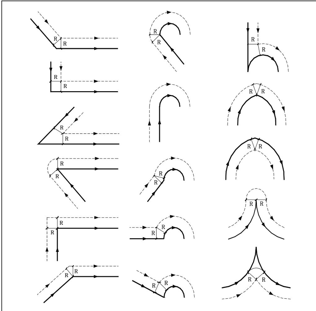
Der Modus, in dem die verschiedenen Bahnen verbunden werden, hängt davon ab, wie der Maschinenparameter COMPMODE angepasst wurde.
