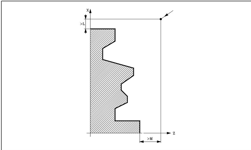
Wenn die Werkzeugposition nicht richtig für die Ausführung des Zyklus ist, zeigt die CNC eine entsprechende Fehlermeldung an. Sobald erst einmal der Festzyklus beendet wurde, ist der aktive Vorschub der zuletzt einprogrammierter Vorschub, der dem Arbeitsgang zur Grobbearbeitung (F) oder Fertigstellung (H) entspricht. Die CNC übernimmt ebenfalls die Funktionen G00, G40 und G90.
