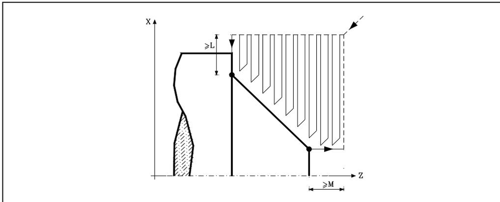
Wenn die Werkzeugposition nicht richtig für die Ausführung des Zyklus ist, zeigt die CNC eine entsprechende Fehlermeldung an.
