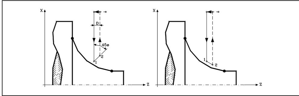
Man muss berücksichtigen, dass, wenn man den Parameter "D" nicht programmiert, die Zeit für die Ausführung des Zykluses größer ist, aber Materialmenge, die beim Durchlauf zur Fertigstellung abgetragen wird, ist geringer.
