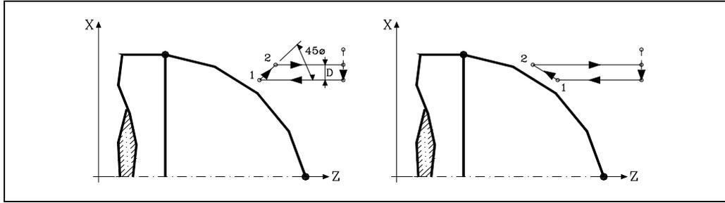
Man muss berücksichtigen, dass, wenn man den Parameter "D" nicht programmiert, die Zeit für die Ausführung des Zyklus größer ist, aber Materialmenge, die beim Durchlauf zur Fertigstellung abgetragen wird, ist geringer.
