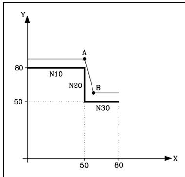
Da der nächste Punkt auf der kompensierten Bahn der Punkt B ist, verfährt die CNC das Werkzeug auf diesen Punkt über die Bahn A - B.
