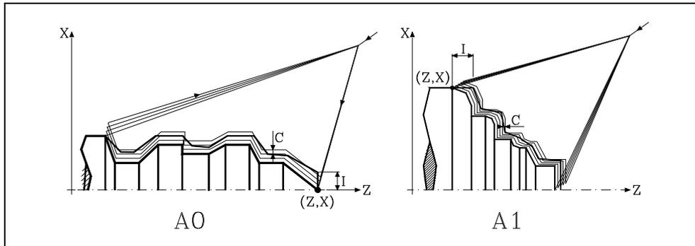
Ohne Programmierung des A-Parameters hängt der I- und C-Wert der Werkzeug-Abmessungen ab.
