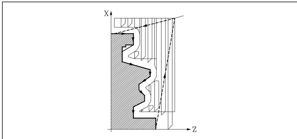
Sobald erst einmal der Durchlauf zur Fertigstellung beendet wurde, fährt das Werkzeug zu dem Punkt zurück, wo der Aufruf des Zyklus erfolgte.
