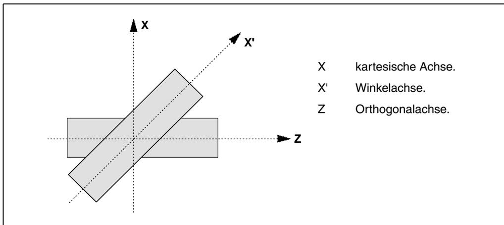
Damit man im kartesischen System (Z-X), programmieren kann, muss man eine Winkelumwandlung der geneigten Achse aktivieren, damit die Bewegungen bezüglich der tatsächlichen nicht senkrechten Achsen umgewandelt werden (Z-X'). Auf diese Art und Weise wird eine programmierte Bewegung auf der X-Achse zu Bewegungen auf den Z-X'-Achsen; das heißt, dass sie zu Bewegungen auf der Z-Achse und der Winkelachse X' werden.
