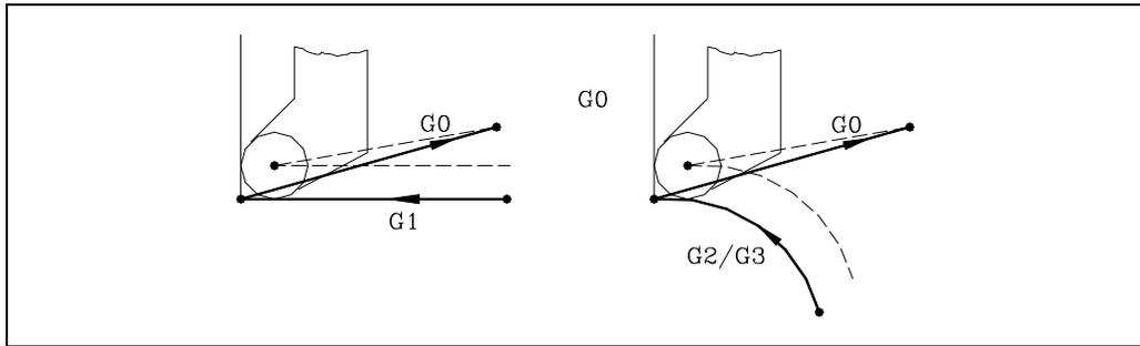
Wenn ein Arbeitsschritt G00 bis G01, G02, G03 G33 oder G34 entdeckt wird, erhält der neue Satz eine Bearbeitung, die dem ersten Kompensationspunkt entspricht, wobei die Radialkompensation normalerweise wiederaufgenommen wird.
