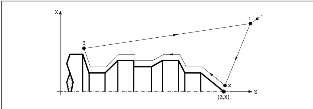
1. Die Verschiebung zum Zustellpunkt "1-2" erfolgt im Schnellgang (G00).
