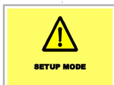
Das Gerät zeigt auf der Arbeitsfläche folgendes Symbol auf rotem Hintergrund an; damit wird der aktive Arbeitsmodus angezeigt und es wird auch darauf hingewiesen, dass es sich um einen nicht sicheren Modus handelt.
