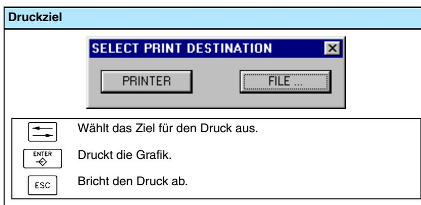
Nach der Auswahl des Zielorts zum Drucken der Tabelle die Taste [ENTER] drücken oder die Taste [ESC], um das Drucken abzubrechen.
