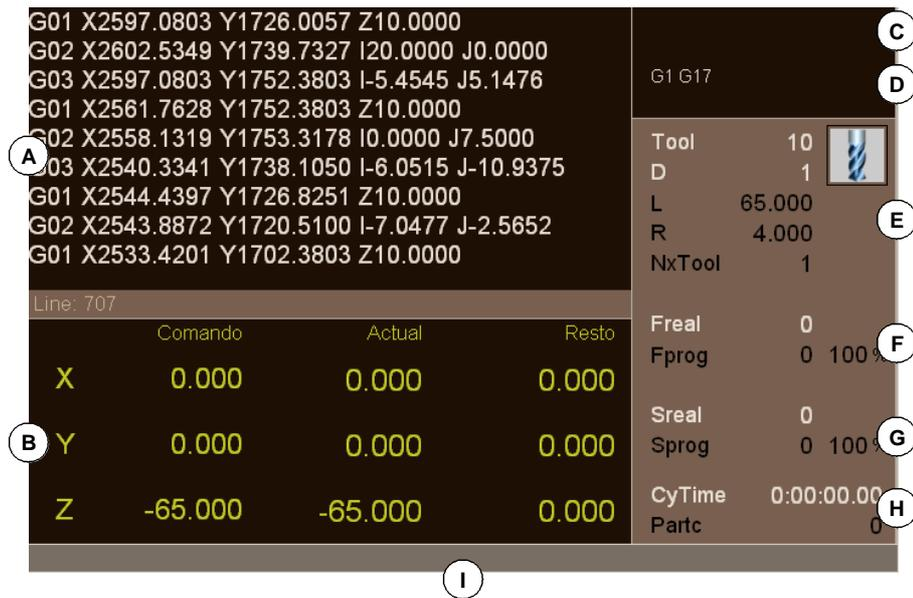
**A.** Programmfenster. Zeigt Information über das für die Ausführung angewählte Programm und ermöglicht die Anwahl des Ausgangs- und Endsatzes der Ausführung. Es wird folgende Information gezeigt.
