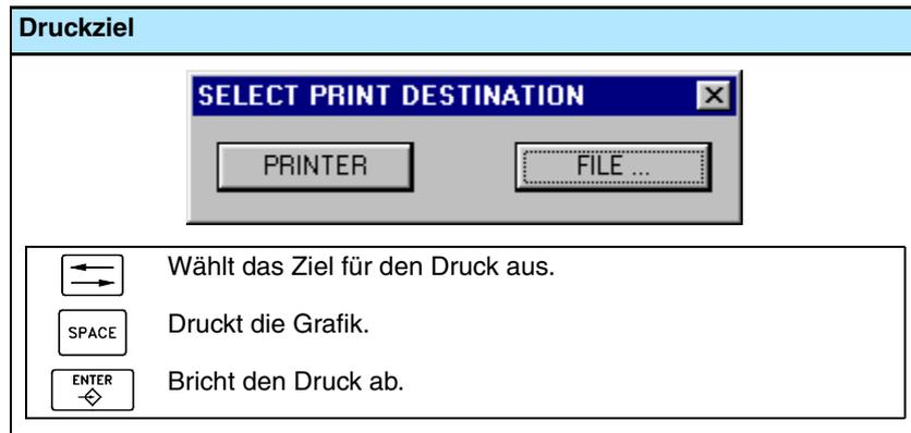
Nach dem Auswählen der Zieldatei betätigen Sie die Taste [ENTER], um den Ausdruck zu starten. Zum Abbruch der Betriebswahl die Taste [ESC] drücken.
